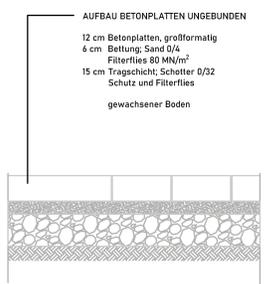
D1.01. Aufbau Befestigung in ungebundener Bauweise
